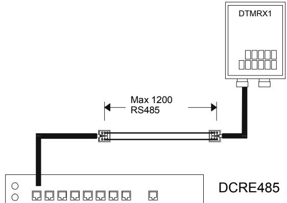
Для подключения к клеммной колодке приемников обратиться к соответствующим руководствам пользователя.
