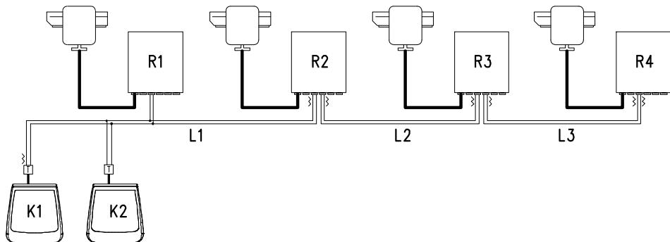
Nell'esempio proposto, un eventuale blocco del ricevitore R1 (collegato in multipunto sulla linea L1) non causa il malfunzionamento del ricevitore R2. R1 non è ai capi della linea L1, e quindi non deve essere terminato. Se il ricevitore R2 dovesse bloccarsi, essendo questo il 'generatore' della linea L2, tutti i ricevitori ad esso collegati in cascata (R3 ed R4) non riceveranno comandi.
