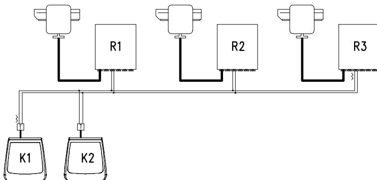
Gli estremi (Tastiera K1- Ricevitore R3) devono avere la resistenza di terminazione inserita. I ricevitori R1, R2 e la tastiera K2 non devono avere la resistenza di terminazione inserita. La lunghezza massima della linea, da capo a capo (dalla tastiera K1 al ricevitore R3), è di 1200 metri.
