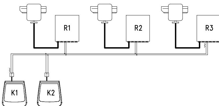
На концах (кнопочная панель K1- приемник R3) должно быть подключено оконечное сопротивление. На приемниках R1, R2 и кнопочной панели K2 оконечное сопротивление не должно быть подключено. Максимальная длина линии, от одного конца до другого (от кнопочной панели K1 к приемнику R3), составляет 1200- м.
