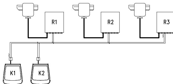
La résistance de terminaison des extrémités (Pupitre K1- Récepteur R3) doit être connectée. Les récepteurs R1, R2 et le pupitre K2 ne doivent pas avoir la résistance de terminaison connectée. La longueur maximale de la ligne, d'une extrémité à l'autre (du pupitre K1 au récepteur R3), est de 1200 mètres.
