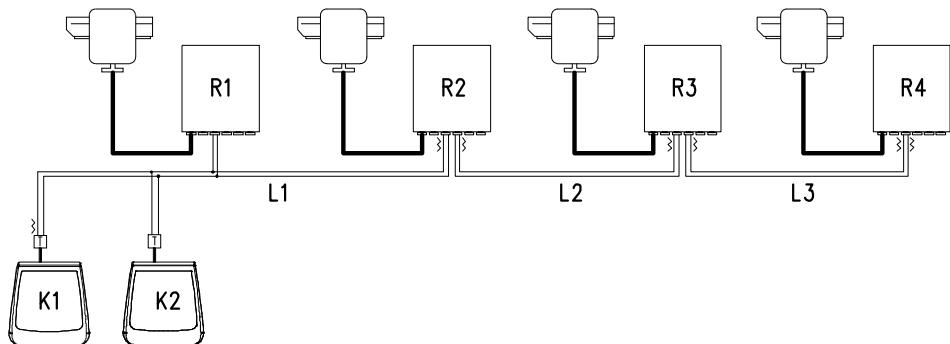
На предложенном примере возможная блокировка приёмника R1 (подсоединённого к линии L1 многоточечным образом) не приводит к сбоям приёмника R2. R1 находится не на концах линии L1, поэтому окончание не требуется. Если приёмник R2 заблокирован, будучи "генератором" линии L2, все приёмники, подключенные к нему в каскаде (R3 и R4), не будут получать команды.
